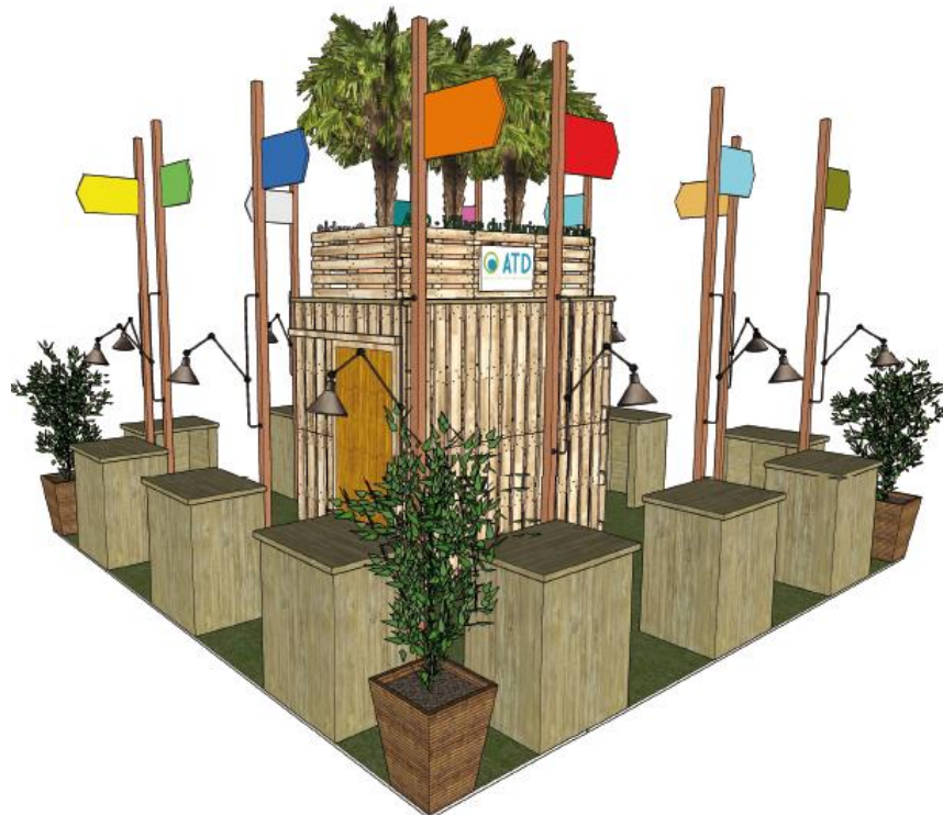
Le stand ATD «Village du tourisme Durable» (36m2) avec 12 pupitres et un local de stockage central. Construit à base de palettes et bois de construction. Le stand est entièrement recyclable après le salon.
